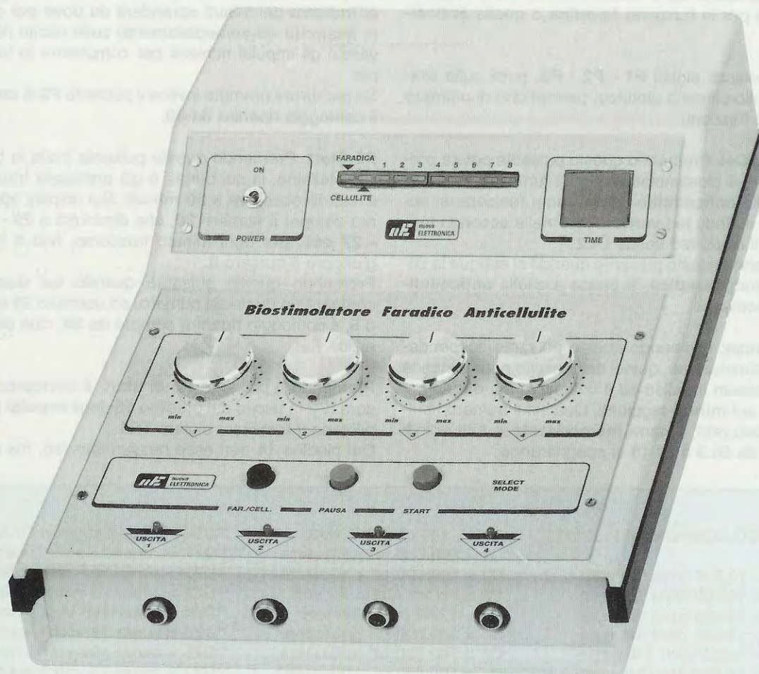
Fig.1 Questo apparecchio serve per fare della ginnastica muscolare passiva (impulsi faradici) e per curare la cellulite (impulsi cellulite). A fine articolo troverete i disegni con le posizioni in cui applicare le placche in gomma conduttrice.
