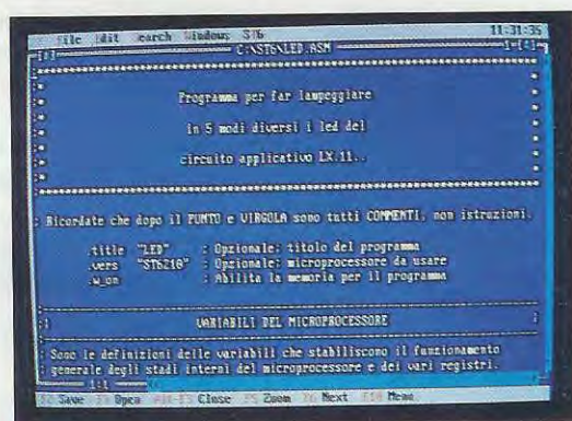
Fig.4 Se sceglierete il programma Led, sullo schermo del computer appariranno tutte le righe di tale programma. Per uscire da questo listato dovete premere Alt ed F3 e apparirà il menu principale.
