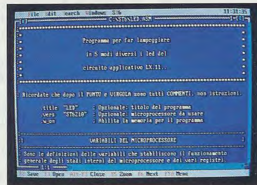
Fig.4 Se sceglierete il programma Led , sullo schermo del computer appariranno tutte le righe di tale programma. Per uscire da questo listato dovete premere Alt ed F3 e apparirà il menu principale.
