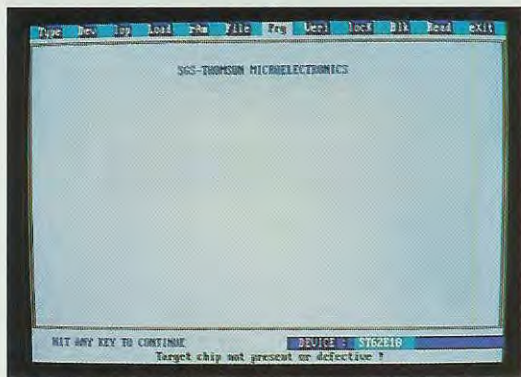
Fig.11 Se il microprocessore è stato inserito nello zoccolo textool in modo errato o se il programmatore non è alimentato, sullo schermo del computer apparirà questo messaggio.
