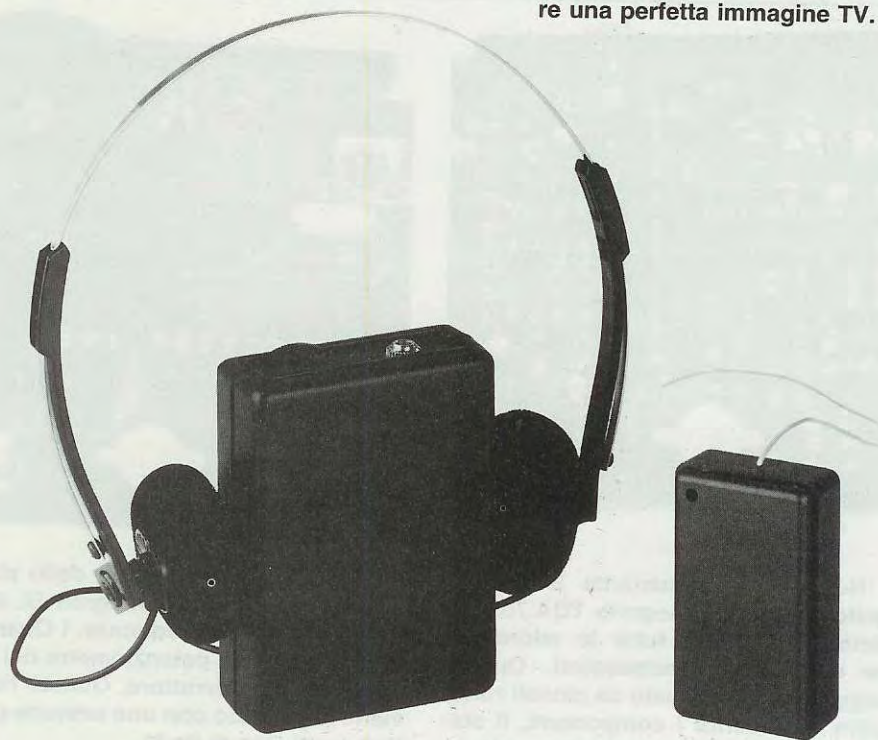
Fig.9 Il microtrasmettitore ed il ricevitore li potete utilizzare per controllare a distanza un piccolo che dorme nella culla o un anziano malato. Può servire anche per comunicare con chi è sul tetto di una casa per direzionare un'antenna oppure una parabola in modo da riuscire a ricevere una perfetta immagine TV.
