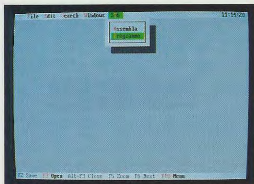
Fig.17 Se portate il cursore sulla scritta ST6 e premete Enter o pigiate i tasti Alt+T, apparirà questa finestra che vi permetterà di programmare l'ST6 inserito nello zoccolo textool del programmatore.
